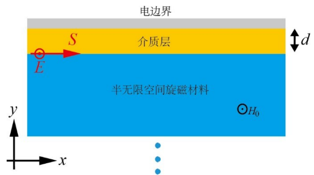
图 1 基于半无限旋磁介质单向表面磁等离子体激元(SMPs)的示意图模型
